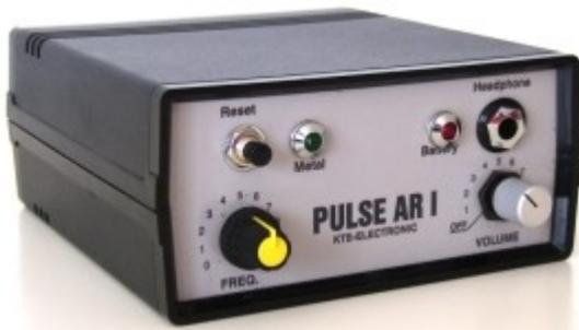
Ein angenehmer klingender und gut wahrnehmbarer Ton signalisiert die Annäherung an ein Metallobjekt. Dank der vorhandenen Kopfhörerbuchse, kann die akustische Anzeige sowohl über Lautsprecher als auch über Kopfhörer erfolgen.
